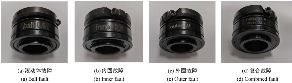
图 12 不同故障状态的滚动轴承
