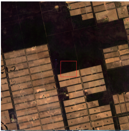
图 16 高光谱相机在轨动态 MTF 刃边测试场景
