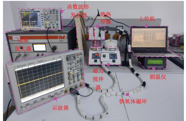
图 7 交流功率定标量热法测量平台
