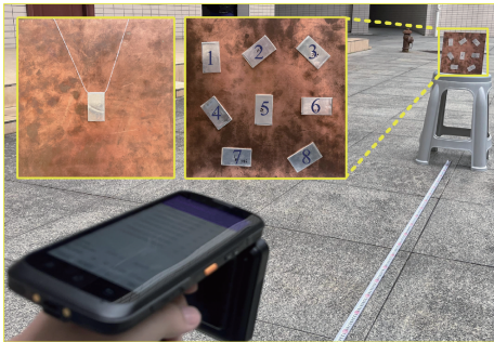
图 14 自由空间下单标签和多标签测试场景
