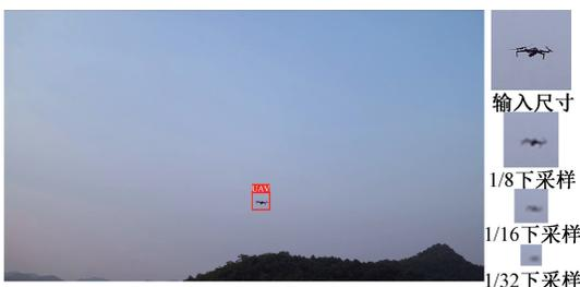
图 3 YOLOv8 中无人机目标下采样示例
