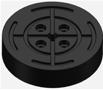
图 1 晶圆吸盘模型 Fig. 1 Wafer chuck model
