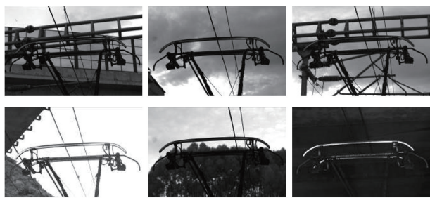
图4 接触网动态检测复杂环境干扰
