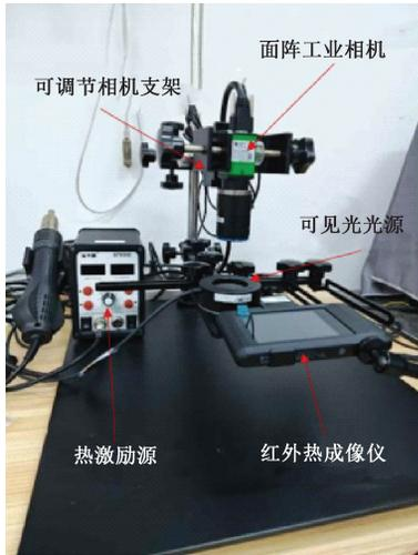
图7 IC器件表面缺陷检测多光谱视觉平台
