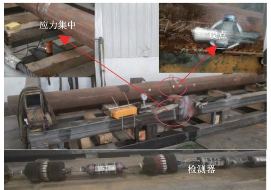
图 20 管道拖拉试验图
