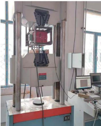
图 16 拉伸试验装置图
