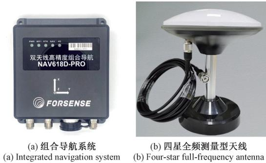
图 11 基准数据采集装置
