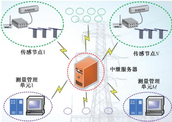
图1 无源无线电缆电流测量系统组成
