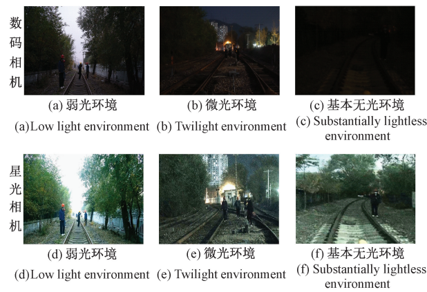
图 8 数码相机和星光相机捕获图像对比
