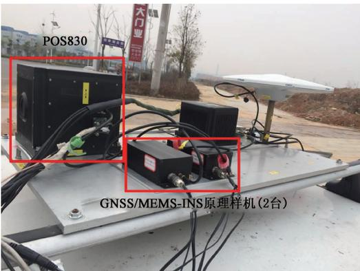
图 2 实验设备安装图
