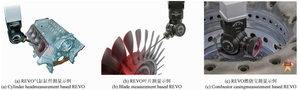
图2 五轴 REVO 测头的应用案例
