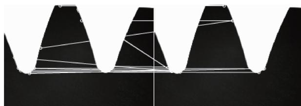
图2 齿轮原始图像特征点提取与匹配结果
