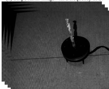
(d) 频率为81的条纹光栅图像
