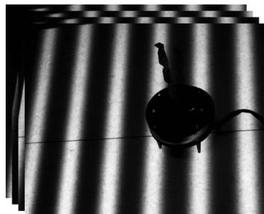
(b) 频率为9的条纹光栅图像
