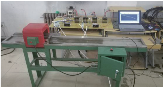
图 12 拖拉试验装置图 Fig. 12 Drag test device
