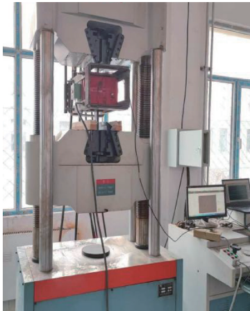
图 16 拉伸试验装置图 Fig. 16 Stretching test device
