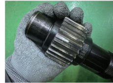
(b) 小齿轮50%断齿实物图
