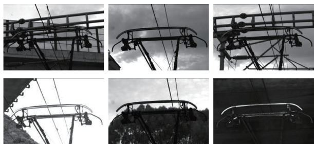
图4 接触网动态检测复杂环境干扰
