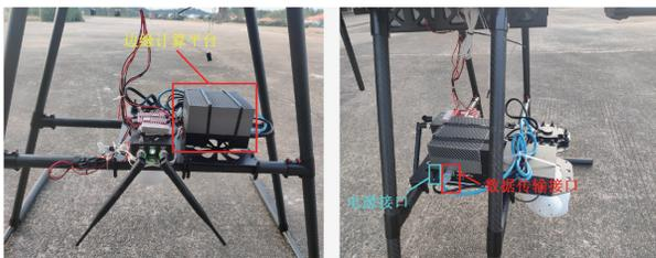
图 10 NVIDIA Orin 边缘计算平台实物
