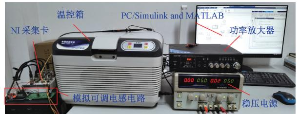
图8 谐振式压电悬臂梁温控质量测量装置
