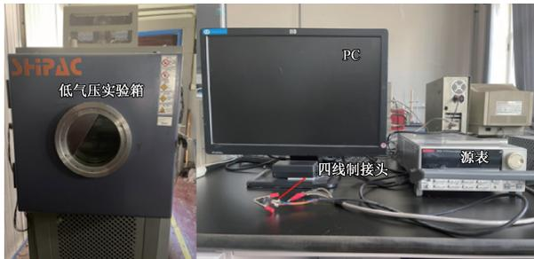
图 5 热耗散系数测试仪器
