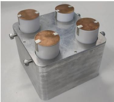
图 13 抗电荷干扰三维电场传感器照片
