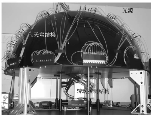
图4 约翰霍普金斯大学光纤式天穹模拟系统 Fig. 4 Optical fiber dome simulation system of Johns Hopkins University
