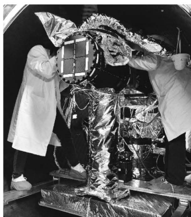
图 9 双频激光真空干涉测量系统
