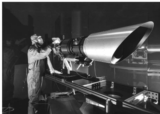
图7 BALL 公司双光楔激光星场模拟系统 Fig. 7 Simulation system of laser star field with double optical of BALL
