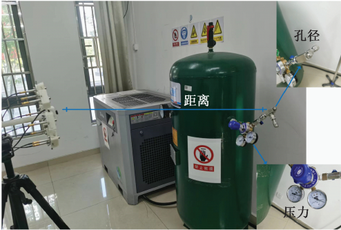
图 5 模拟泄漏信号采集 Fig. 5 Analog leak signal collection
