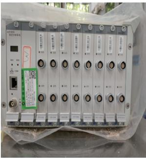
图 6 振动台检测的数据采集仪
