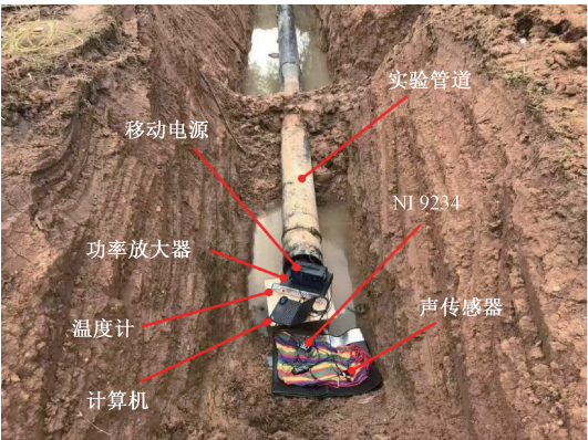
图1 液面测量实验平台
