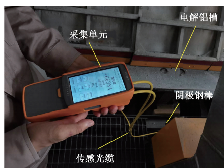
(a) 某电解槽阴极钢棒电流测试场景
