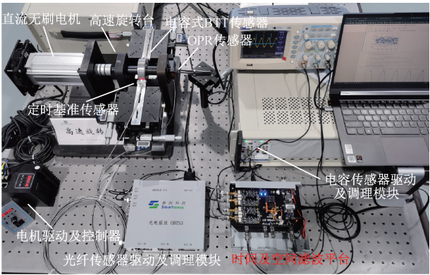
图 19 空域滤波验证实验系统组成
