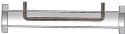
图1 电磁波相位传感器结构示意图
