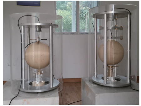
图 8 研制的地磁矢量测量仪架设在蒙城地震台 Fig. 8 The prototype system set up at Mengcheng geomagnetic station
