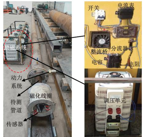
图11 高速漏磁检测平台
