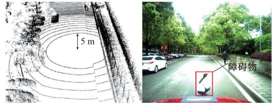
图 12 激光雷达和相机的近距离观测范围
