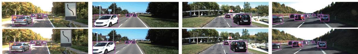
(a) YOLOv3左右图像检测结果
