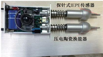
(b) 压电陶瓷激励装置
