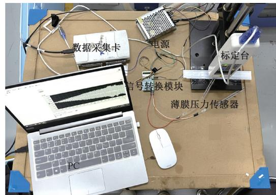
图 13 薄膜压力传感器静力标定实验台
