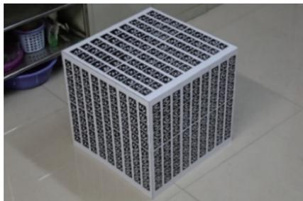
图 19 粘贴环状编码点的亚克力正六面体
