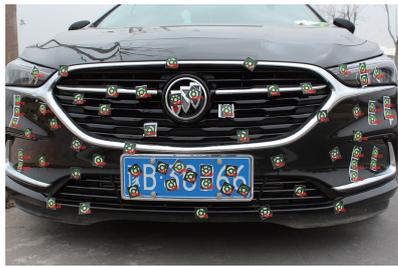
图 24 汽车上环状编码点的识别结果
