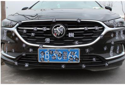
图 23 粘贴环状编码点的汽车
