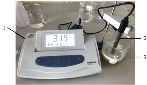
1-电导率仪;2-测量电极;3-海参溶液
