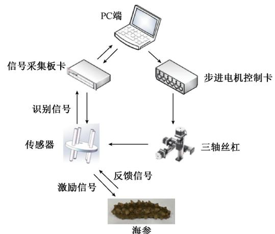
图6 海参识别试验平台的工作流程
