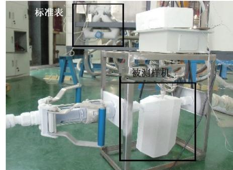
图 14 低温流量测试现场
