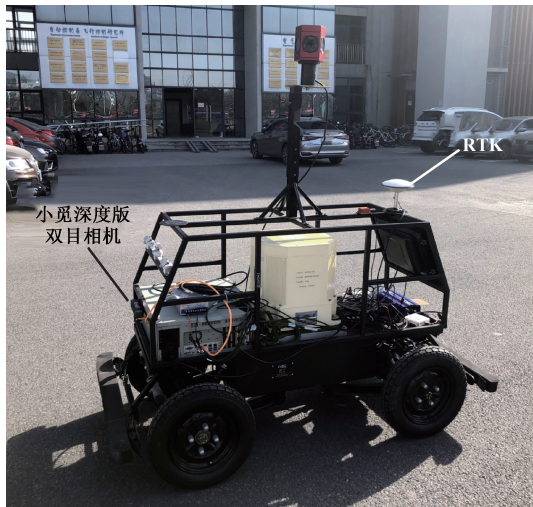
图6 无人车试验平台
