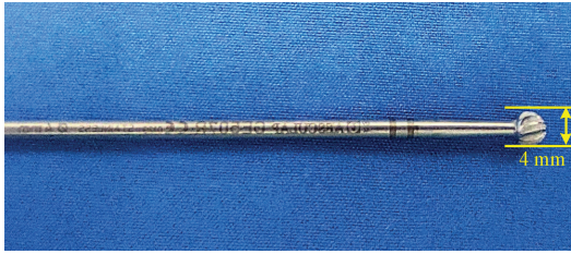
图4 用于切骨实验的4 mm医用球形铣刀
