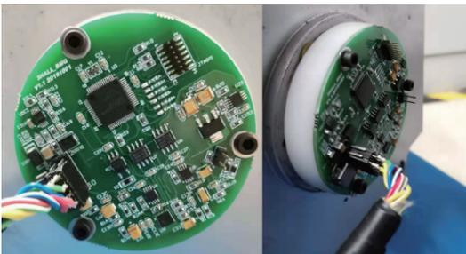
图 21 磁电编码器信号处理板
