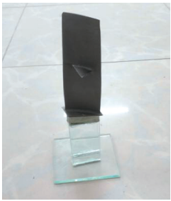
图 14 被测的 RB199 叶片
