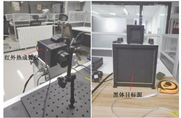
图 10 实验用红外热成像仪和黑体目标源
