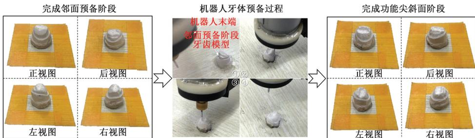
图 20 机器人完成功能尖斜面预备阶段的实验过程
