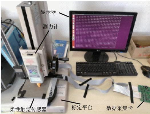
图4 触觉传感器标定实验
