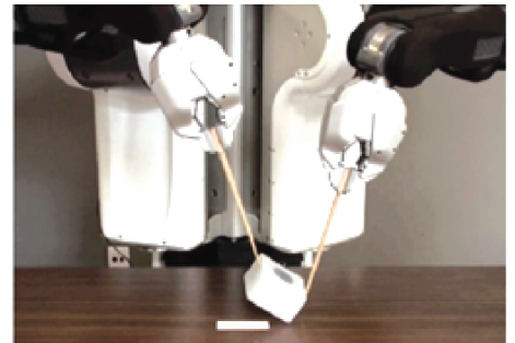
(b) 用筷子翻箱子任务 (b) Manipulating a box using chopsticks
