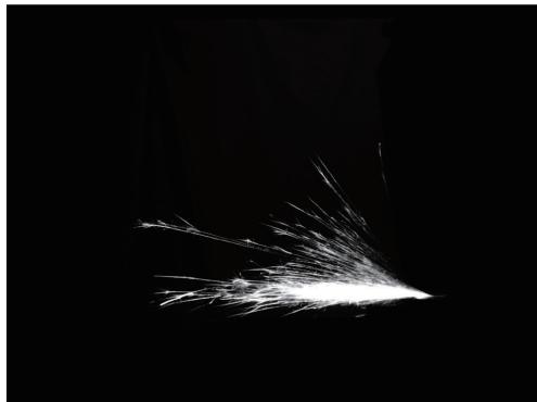
(c) 分割后的火花区域图像 (c) The spark image after segmentation
