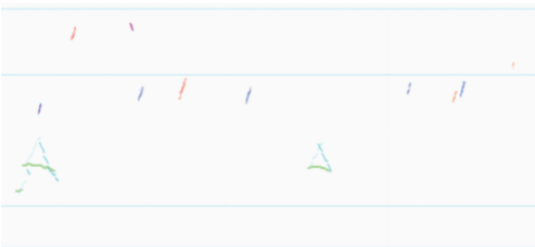
图 11 超声脉冲采样间隔 6 mm 时人工伤损检测图谱
