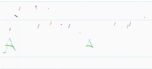
图 10 超声脉冲采样间隔 1 mm 时人工伤损检测图谱
