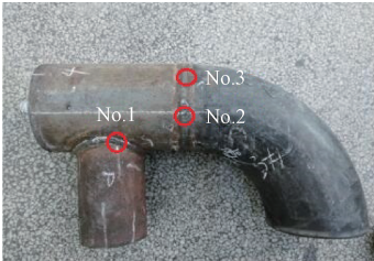
图 9 弯管焊接结构试件
