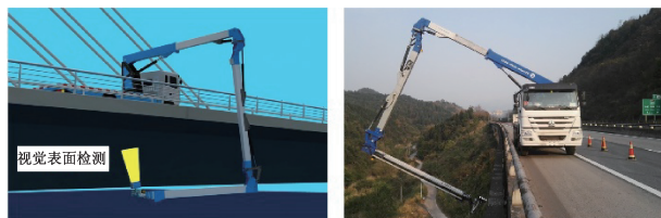
图2 桥梁检测机器人工作原理
